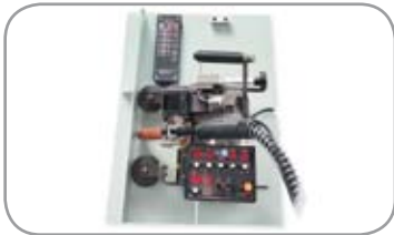
CS-51WE радиоуправляемая сварочная каретка для сварки вертикальных швов
