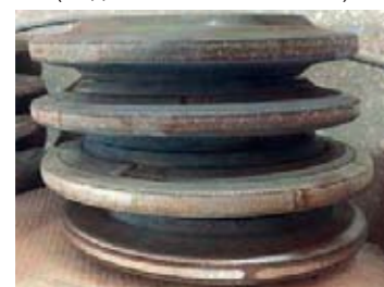
Диски проходческого комплекса (строительство метро)
