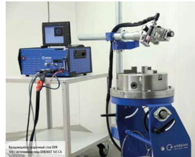
Трёхкулачковые патроны для точного позиционирования и фиксации заготовки
